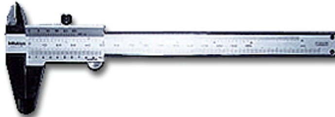
(FIG. 1) Pied à coulisse à vernier
